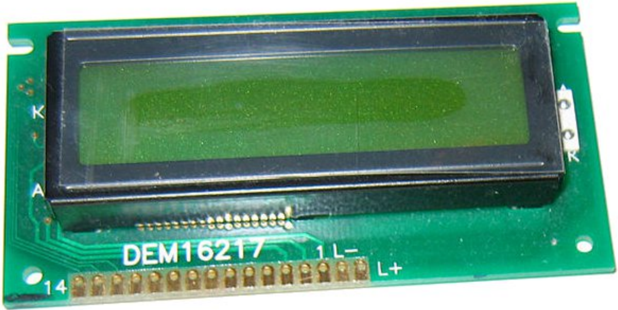
FIGURE 28.3. – Un écran LCD alphanumérique
