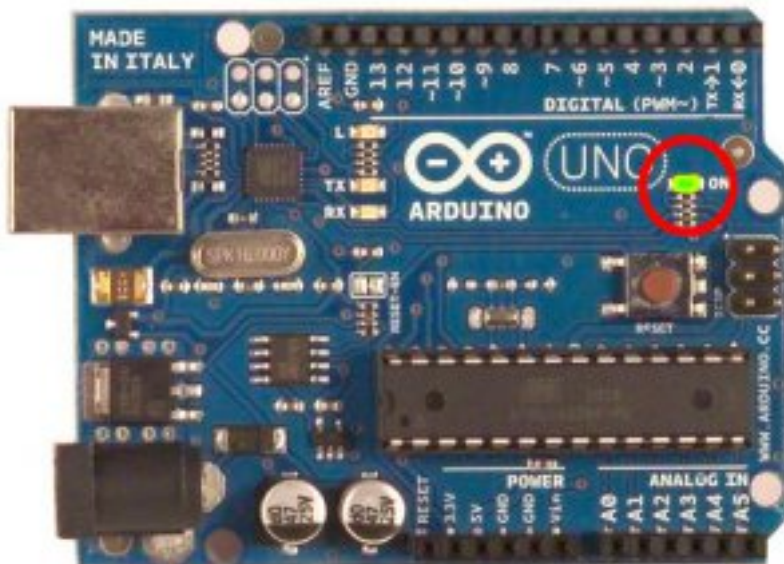
FIGURE 5.3. – Carte connectée et alimentée
